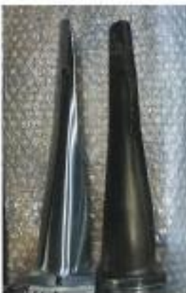
links neu, rechts abgenutzt
