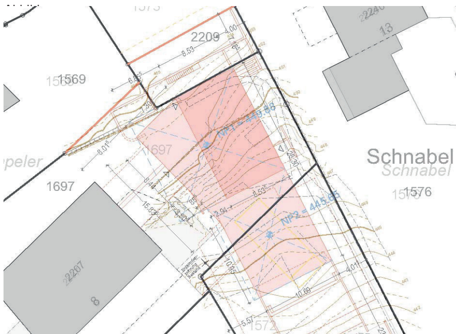
Festlegung der Niveaupunkte für die einzelnen Gebäudeteile
